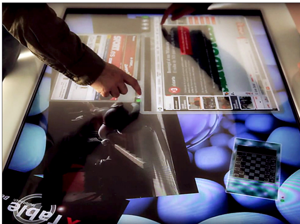
Pantalla multitáctil, multiplataforma que permite más de 50 elementos interactivos simultáneos. DIGALIX
